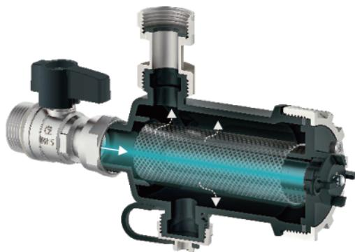
Фильтр устанавливается на обратной линии системы отопления перед входом в теплогенератор.
